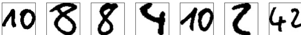
Abbildung 3.8: Die zugeschnittenen Punktzahlen mit Anwendung eines binären Schwellwerts. Es wurde ein schwarzer Rahmen um das Bild gelegt, um die Dimensionen zu verdeutlichen.
