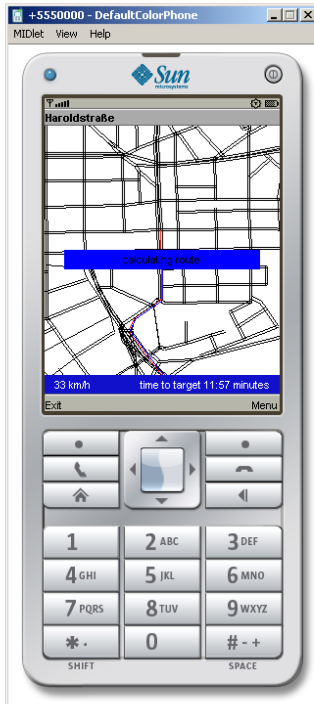
Abbildung 3.7: Screenshot des Navigationsbildschirms des JavaMEPeers während eine neue schnellste Route berechnet wird
