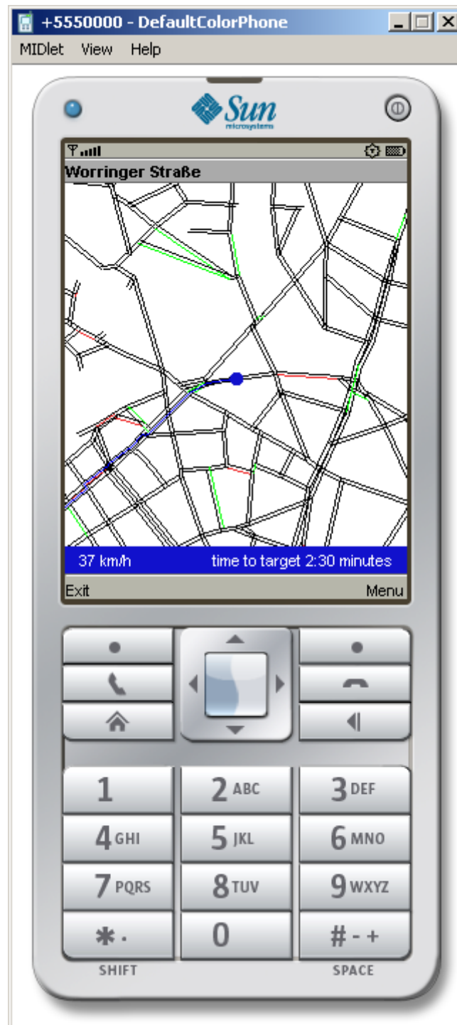
Abbildung 3.8: Screenshot des Navigationsbildschirms des JavaMEPeers während einer laufenden Navigation mit verfügbaren Verkehrsinformationen für einige Kanten
